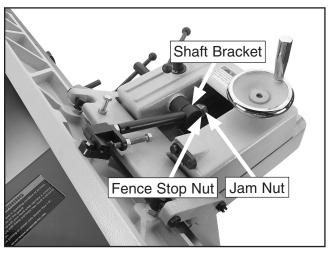
Figure 63. 45° inward fence stop jam nut.
